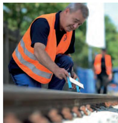
Prüfung der Schweißstoßgeometrie
