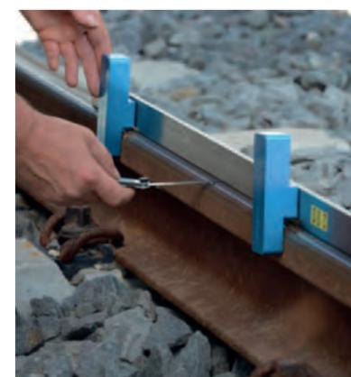
Prüfung der Schienengradheit
