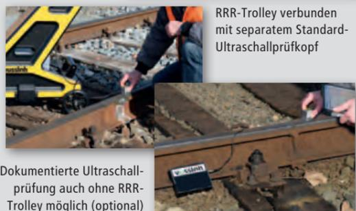
RRR-Trolley verbunden mit separatem Standard-Ultraschallprüfkopf
