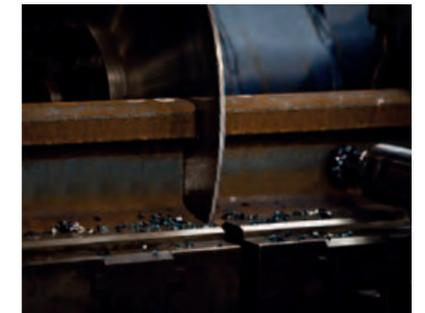
Die exakte Länge wird durch genauen Zuschnitt der Langschiene erreicht
