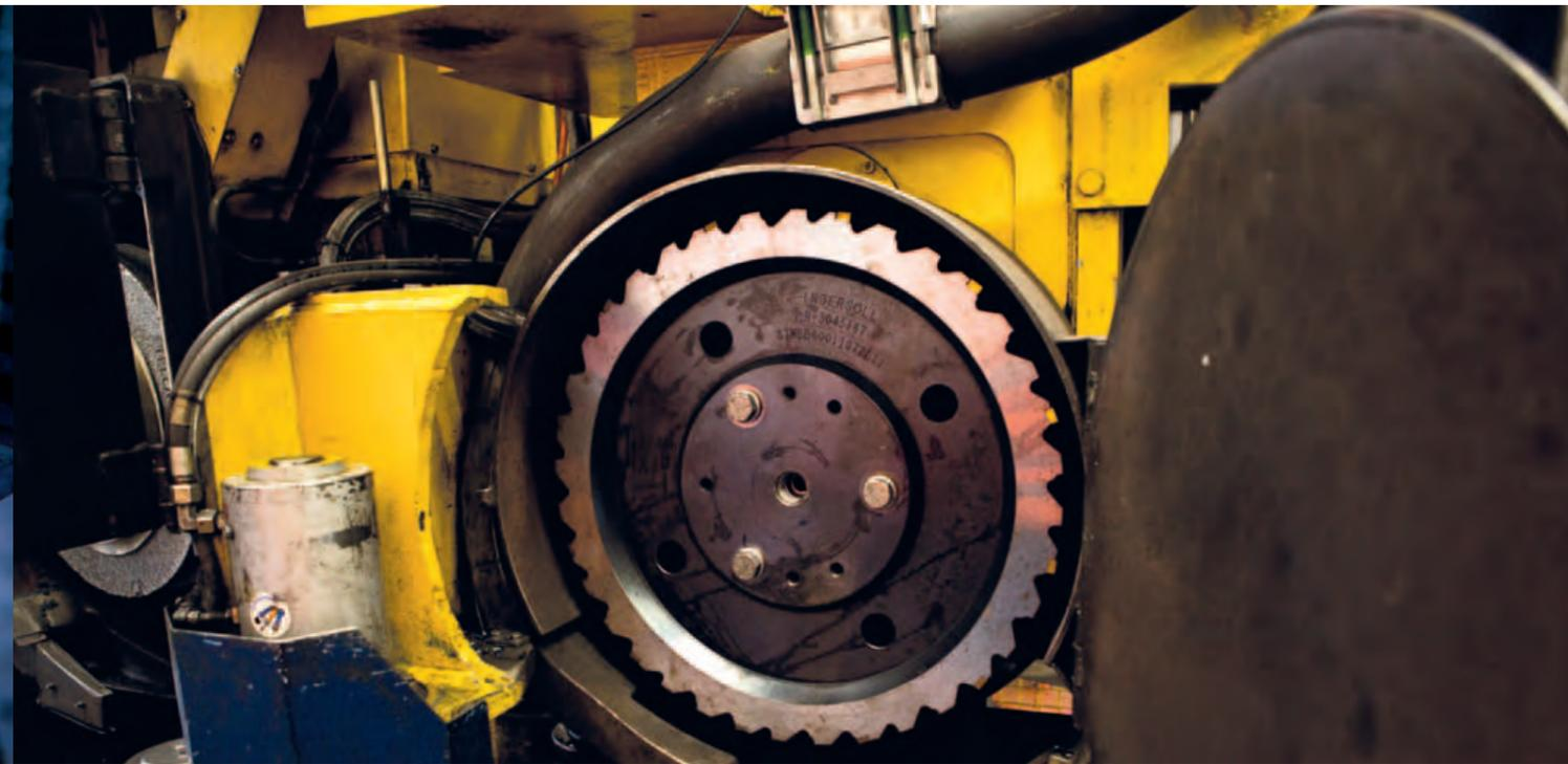
Für alle gängigen Schienenprofile stellen wir im Werk **Profilübergänge** her. Durch kontrollierte Stauchung und Abbrennstumpfschweißung entsteht ein Übergang zwischen Schienen mit unterschiedlichem Profil oder unterschiedlicher Güte. Diese werden im Schienenband oder als Passlänge integriert. An unserem Standort in Finnland beherrschen wir auch das Handschweißen und produzieren Übergänge zwischen Rillen- und Vignolschiene.
