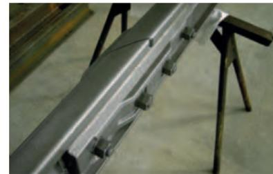
Vollständig verklebter Schrägstoß IVB 30°
