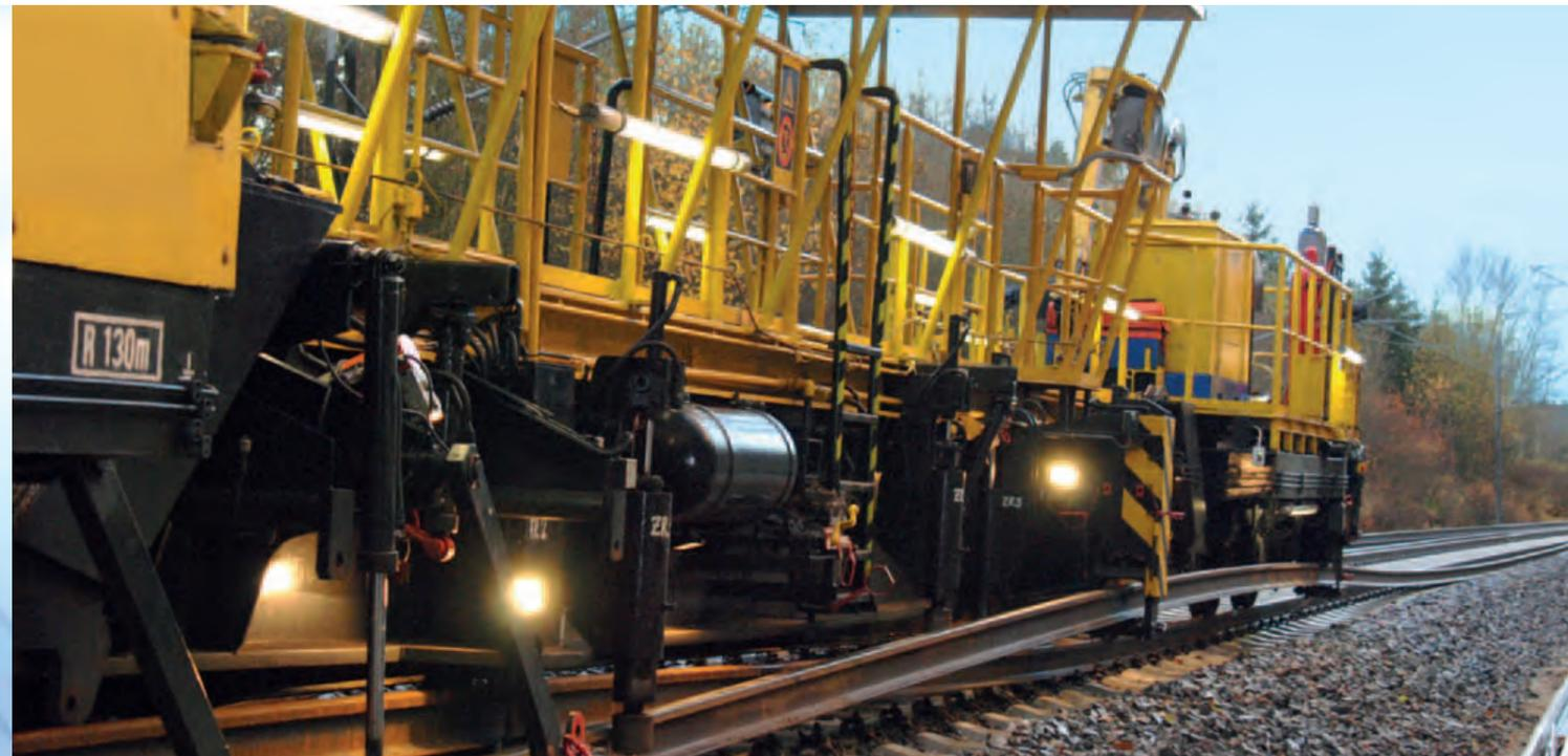
**Einer für alles: der Schienenwechselzug SWW**
