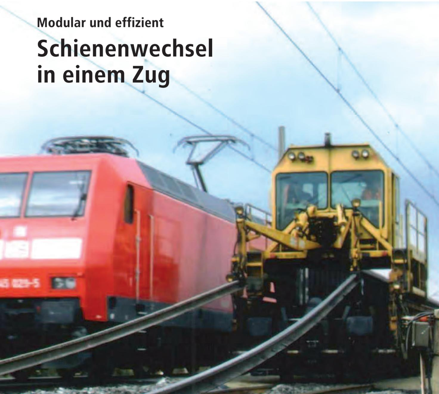
Auch bei bester Schienepflege kommt irgendwann der Zeitpunkt für einen Schienenwechsel. Für diesen großen Eingriff hat Vossloh die perfekte Lösung: unser **Schienenwechselfließbandsystem**.
