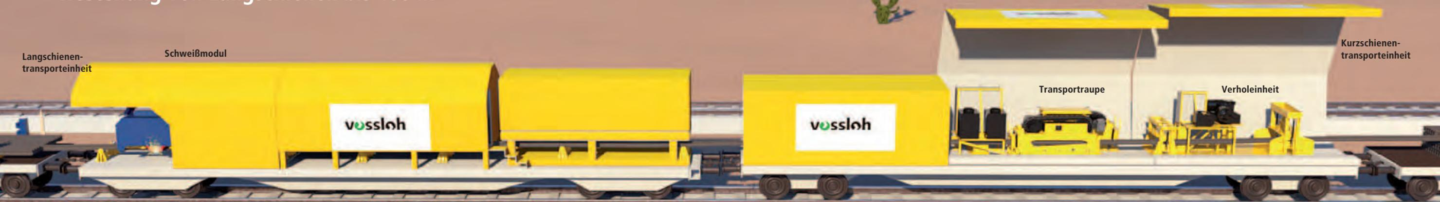
Zu Langschienen verschweißte Kurzschienen werden auf die Transporteinheit verschoben, wo nach Abkühlung der Feinschliff erfolgt.
