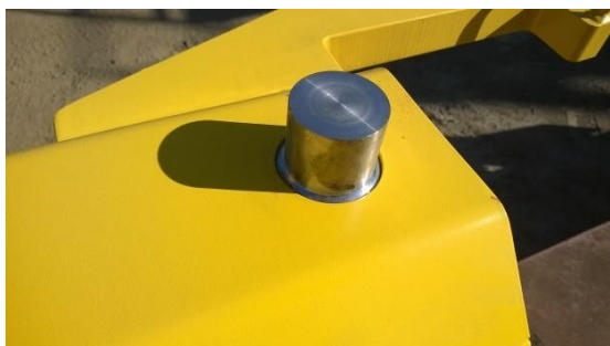
Steckbolzen in Drehschwelle
