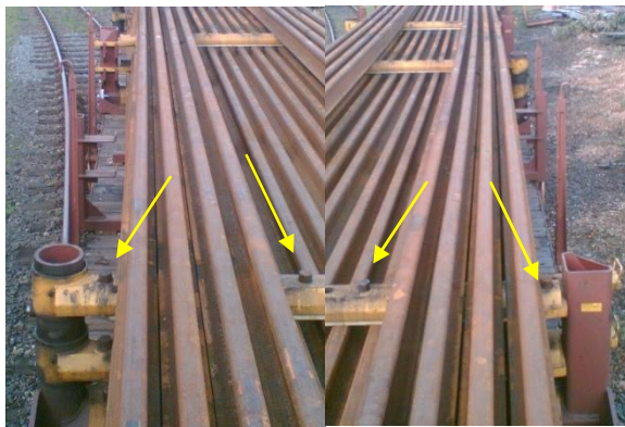
Steckbolzen über Drehgestell: Schienen quer fixiert
