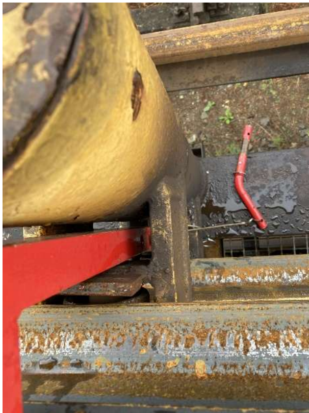
Abbildung 5: Schienensicherungsbügel in die Öffnung des Rollenbocks gesteckt
