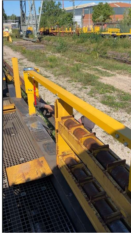
Abbildung 8: Schienensicherungsbügel gesichert (Be- bzw. Entladestellung)
