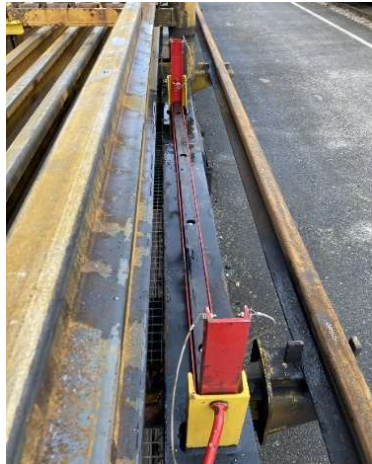
Abbildung 3: Schienensicherungsbügel in Halterung gesichert (linkes Bild) / ungesichert (rechtes Bild)
