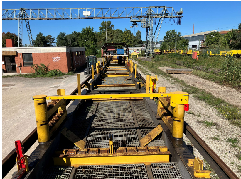
Abbildung 11: Schienensicherungsbügel gesichert in Transportstellung
