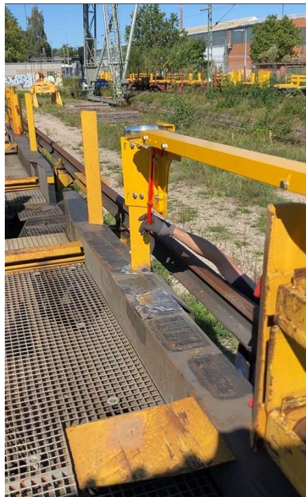
Abbildung 9: Schienensicherungsbügel ungesichert, Entriegelung von Hand durch Betätigen der roten Verriegelungsstange
