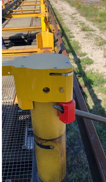
Abbildung 12: Ansetzen der Brechstange in die dafür vorgesehene Bohrung (rotes Bauteil)
