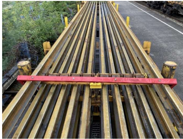
Abbildung 4: Schienensicherungsbügel auf oberer Schienenlage
