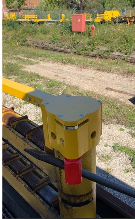
Abbildung 10: Ansetzen der Brechstange in die dafür vorgesehene Bohrung (rotes Bauteil)
