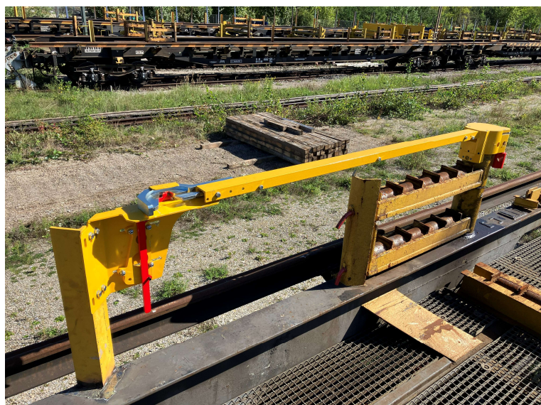
Abbildung 2: Seitenansicht (Mittelwagen Robel TE 180 m) - Schienensicherungsbügel Version 2 in Halterung
