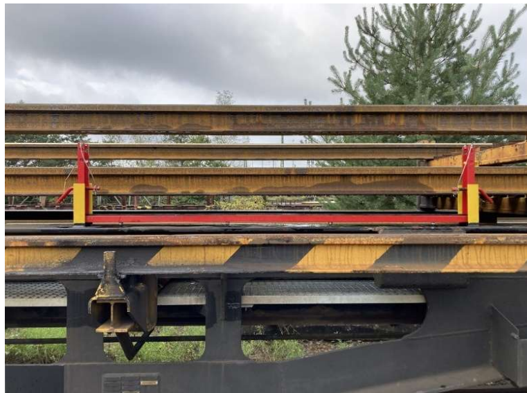
Abbildung 1: Seitenansicht (Mittelwagen Robel TE 180 m) - Schienensicherungsbügel Version 1 in Halterung
