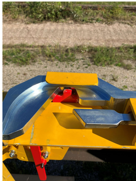
Abbildung 13: Wirkmechanismus der Verriegelung des Schienensicherungsbügels in der Be- bzw. Entladestelle
